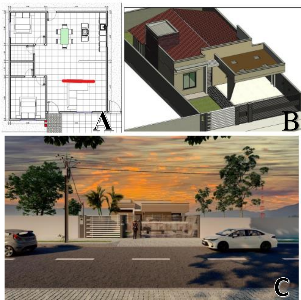
Imagem 7 - Projeto arquitetônico residencial. Figura (A) Planta baixa da construção feito no software Revit; Figura (B) em perspectiva 3D com detalhamento, utilizando o Revit; Figura (C) Maquete eletrônica, com o render feito no Lumion.
