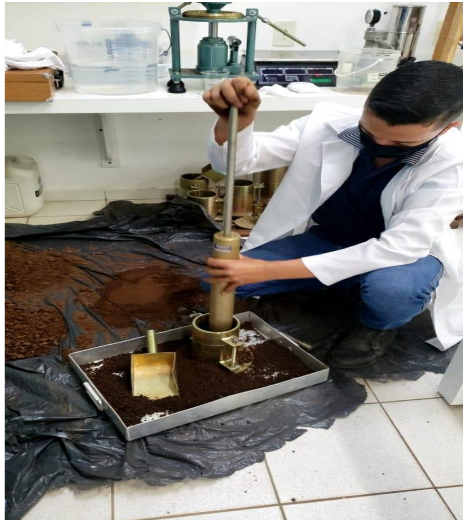
Figura 02: Realização do ensaio de compactação
