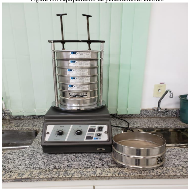
Figura 03: Equipamento de peneiramento elétrico
