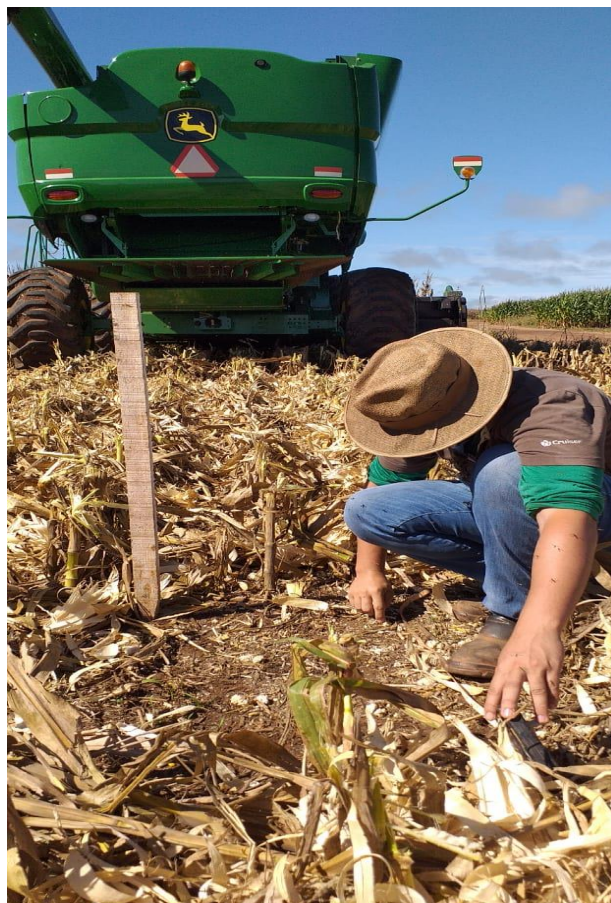
Figura 1 – Coleta dos grãos perdidos após a passagem da colheitadeira previamente regulada para as três diferentes rotações (300, 500 e 700 rpm). Jaciara-MT, 2020. Fonte: Arquivo pessoal do autor.
