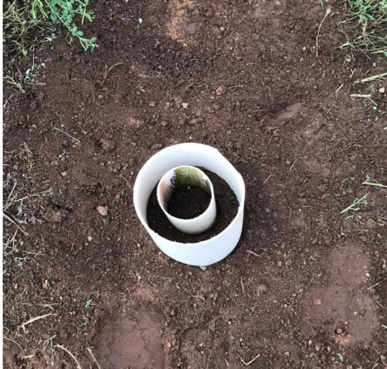
**Figura 1 - Instalação do conjunto de Infiltrômetro de Anéis Adaptado em área sob plantio de abacaxi.**
