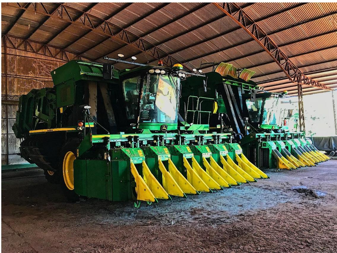
**Figura 3.** Colhedora de algodão marca John Deere, modelo CP 690, com plataforma tipo *Stripper* de escova da marca John deere, com 6 linhas espaçadas a 0,80 m. Jaciara, MT, 2019. Fonte: Jonei Martins.
