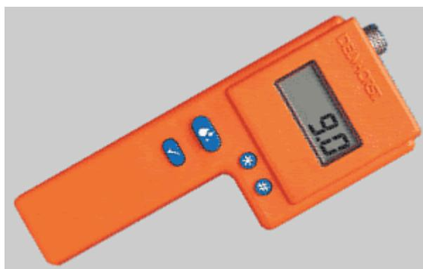
**Figura 4.** Equipamento de medição portátil da marca Delmhorst, utilizado para monitorar a umidade durante a colheita. Jaciara, MT, 2019. Fonte: [Struijctrading.nl/delmhorst](http://Struijctrading.nl/delmhorst).
