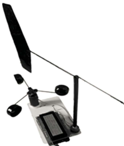
Fig. 2 - estação meteorologia feita com Arduino
