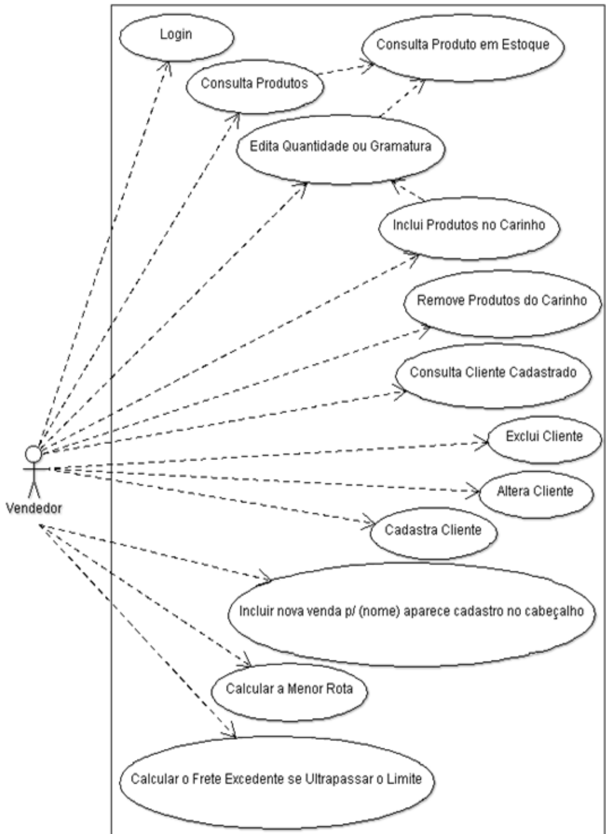
Figura 6 - Diagrama de Caso de Uso (Vendedor) no Sistema na Gestão de Estoque da J.A Construir – (OLIVEIRA, 2015).
